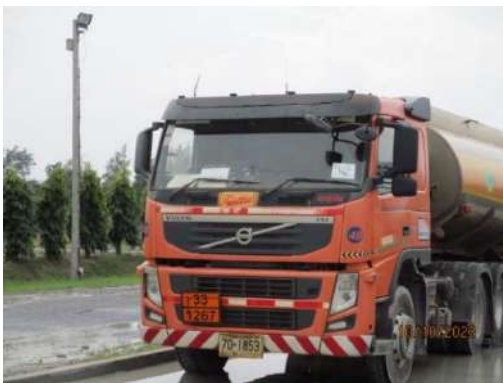
รูปที่ 2-14 รถบรรทุกน้ำมันซึ่งติดตั้งอุปกรณ์ระบุตำแหน่งด้วยดาวเทียม (GPS)
