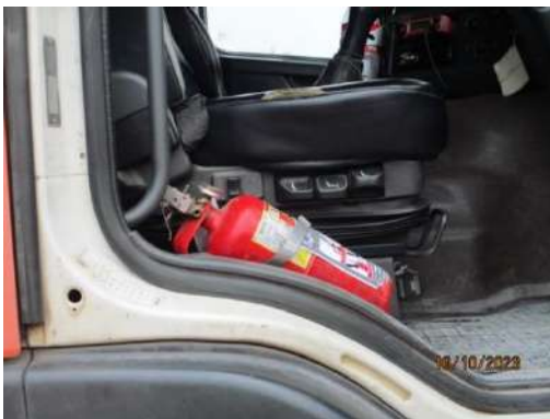
รูปที่ 2-15 รถบรรทุกน้ำมันซึ่งติดตั้งอุปกรณ์ป้องกันเหตุฉุกเฉินบนรถบรรทุกน้ำมัน
