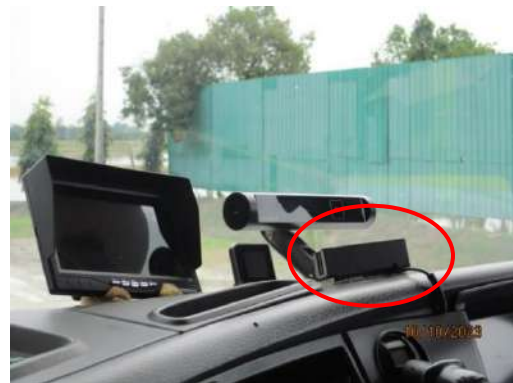
รูปที่ 2-14 รถบรรทุกน้ำมันซึ่งติดตั้งอุปกรณ์ระบุตำแหน่งด้วยดาวเทียม (GPS)
